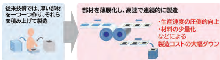
水電解用セルスタックの低コスト製造イメージ
